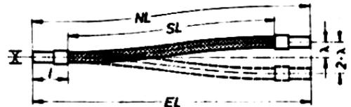
d.h. der Schlauch muss in Mittelstellung um ca. 3 mm.
